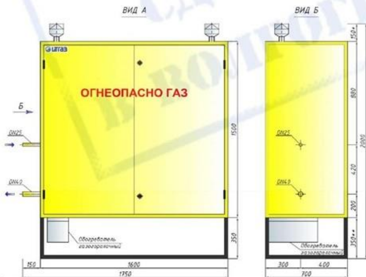
Рисунок 9 – Пневматическая схема и габаритные размеры ШРП «ИТГАЗ-R72»
