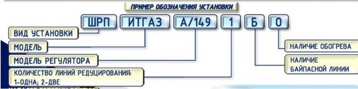
Рисунок 8 – Технические характеристики ШРП «ИТГАЗ-А/149-2»
