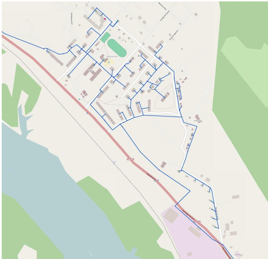
Рисунок 20 Схема сетей водоснабжения пгт. Лесогорский
