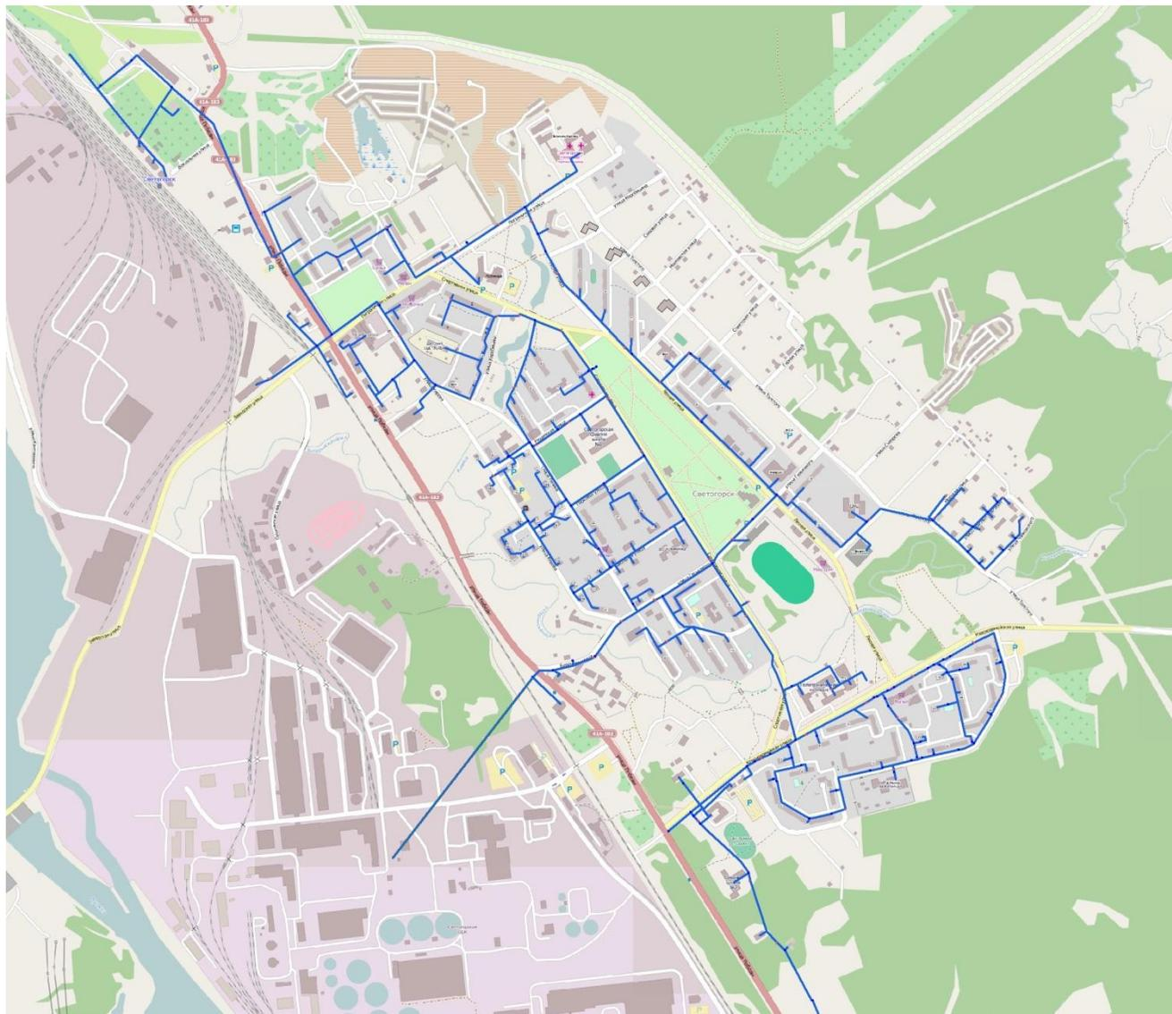
Рисунок 19 Схема сетей водоснабжения г. Светогорска
