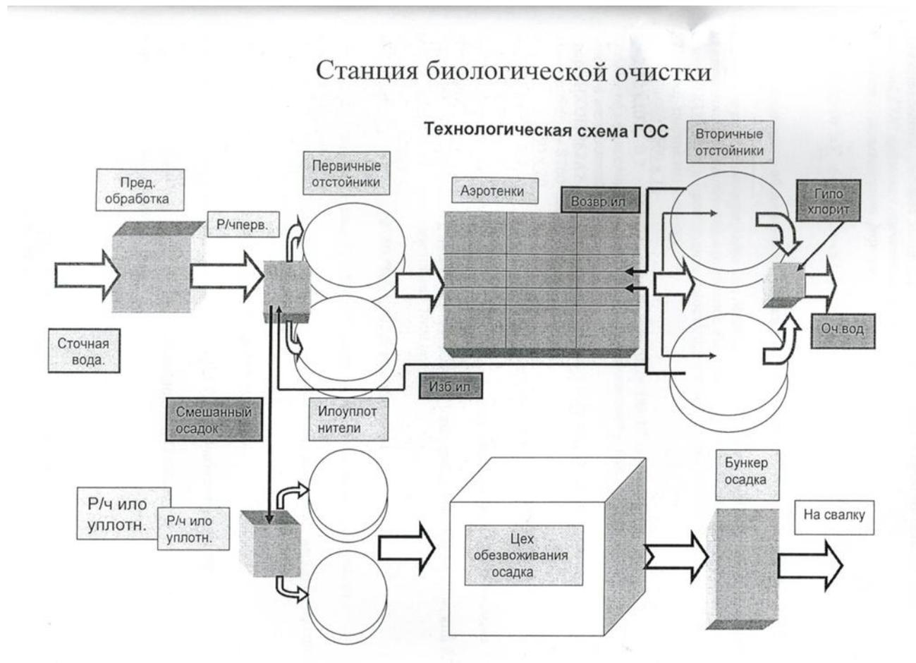
Рисунок 24 Технологическая станция очистки сточных вод г. Светогорска
