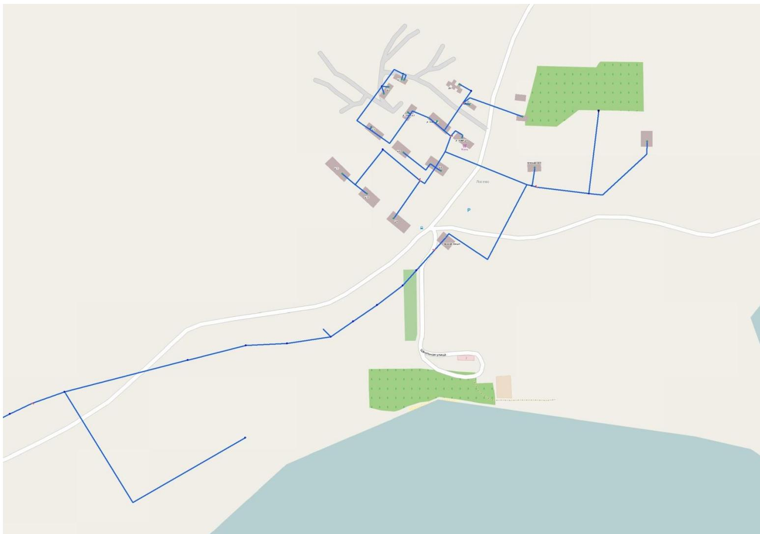
Рисунок 21 Схема сетей водоснабжения д. Лосево
